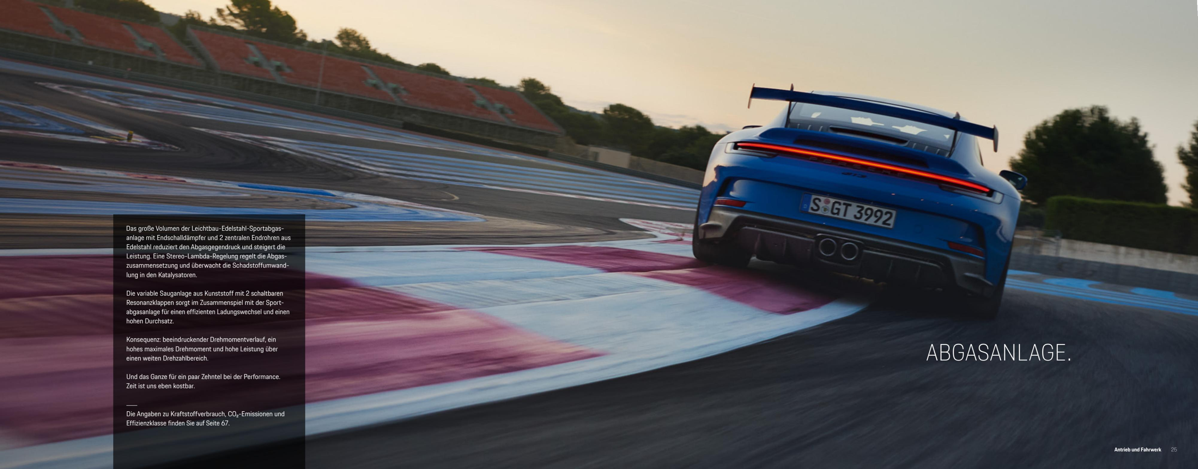
Das große Volumen der Leichtbau-Edelstahl-Sportabgasanlage mit Endschalldämpfer und 2 zentralen Endrohren aus Edelstahl reduziert den Abgasgegendruck und steigert die Leistung. Eine Stereo-Lambda-Regelung regelt die Abgaszusammensetzung und überwacht die Schadstoffumwandlung in den Katalysatoren.
